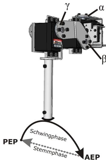
Abbildung 5.1: Schematische Darstellung der Stemm- und Schwingtrajektorie des Fußpunktes zwischen PEP und AEP.
