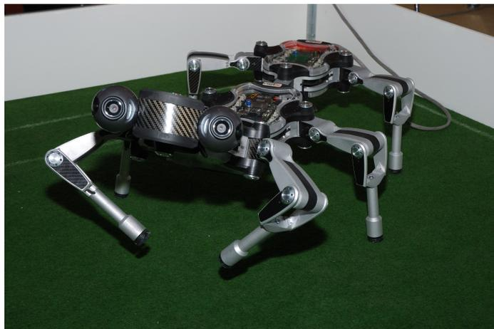
Abbildung 2.4: Die Laufmaschine ANTON © 2007 RobotsLab.
