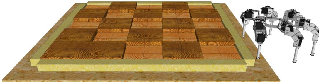
Abbildung 5.19: Testgelände für die Bodendetektion aus 10x10 cm Kanthölzern. Die Kanthölzer sind in Vierergruppen mit verschiedenen Höhen angeordnet.
