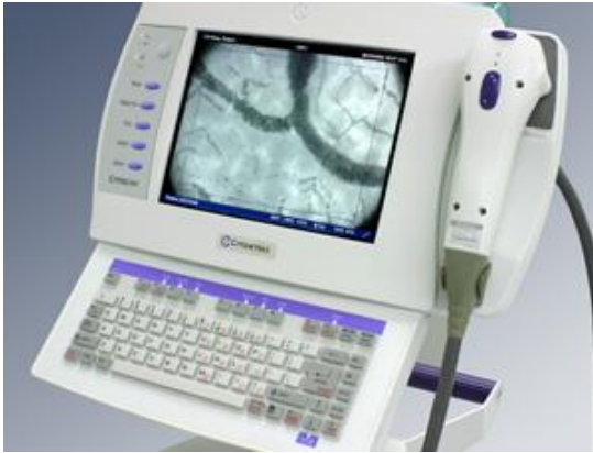
Abbildung 2: Aufbau des OPS ® -Imaging Mikroskopes; das linke Bild zeigt das funktionsbereite Gerät mit Beispielsbild einer Messung der Mikrozirkulation; das rechte Bild zeigt die komplette Messeinheit mit IBM-kompatiblen PC im Untergehäuse (mit freundlicher Genehmigung von Lekam medical limited)
