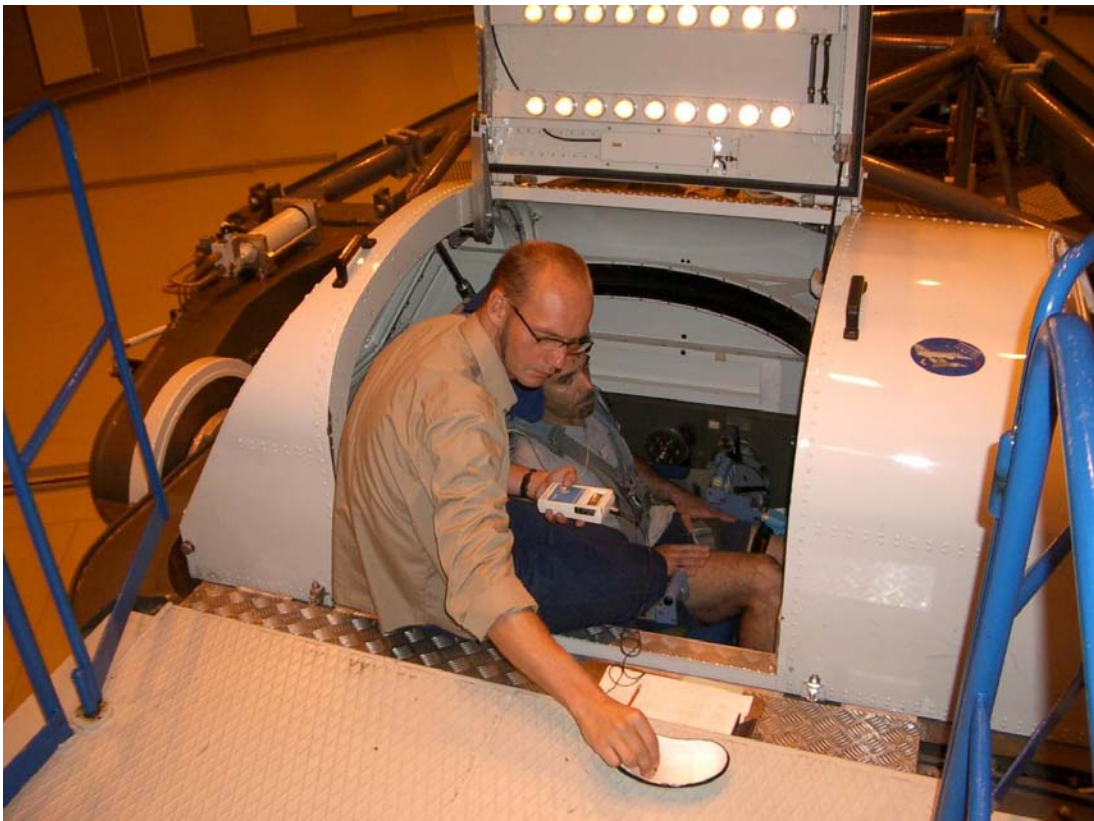
Foto 3: Hochleistungszentrifuge der Luftwaffe in Königsbrück: Geöffnete Probandenkabine während der Hautschichtdickenmessung
