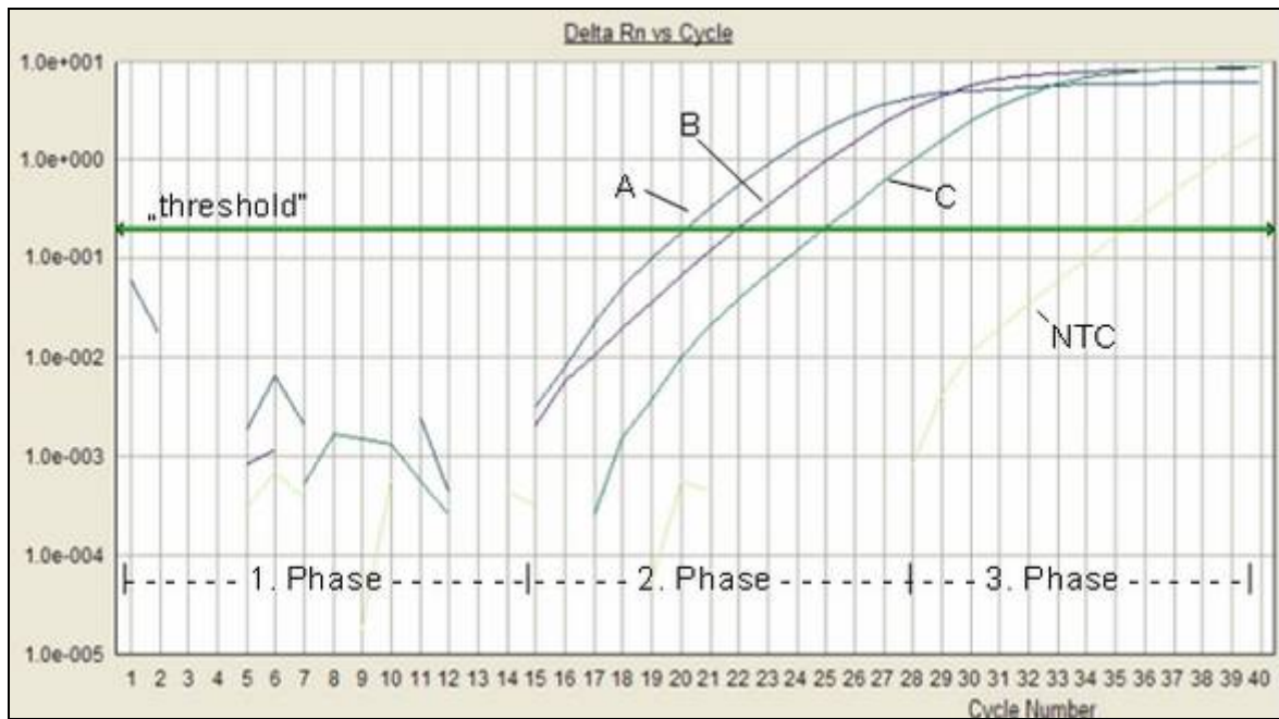
Abb.3: Ct-Grafik: 1.Phase (Zyklus 1-15): die gebildeten PCR-Produkte sind in der Fluoreszenzintensität nicht vom unspezifischen Hintergrund zu diskriminieren; 2.Phase (Zyklus 16-28): die Produktbildung verläuft exponentiell, je höher die Ausgangskonzentration der DNA, desto eher wird der Messgrenzwert („threshold“) geschnitten (A=höchste, B=mittlere, C=geringste Ausgangskonzentration); 3.Phase (Zyklus 29-40): die Produktbildung geht in eine gesättigte Phase über, es erfolgt kein Fluoreszenzzuwachs. NTC= Leerwert mit Primerdimer-Fluoreszenz.
