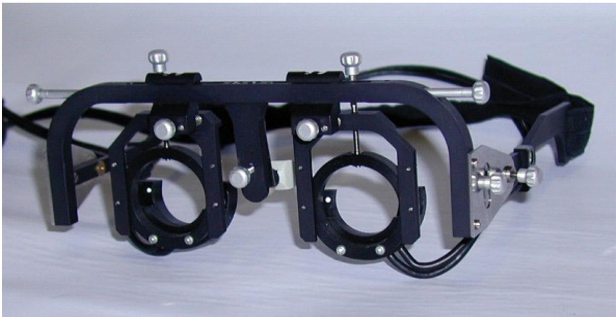
Abbildung 4 zeigt die verwendete Messbrille von hinten und vorne, die mit Hilfe der Infrarotreflex-Okulographie die Augenbewegungen misst.
