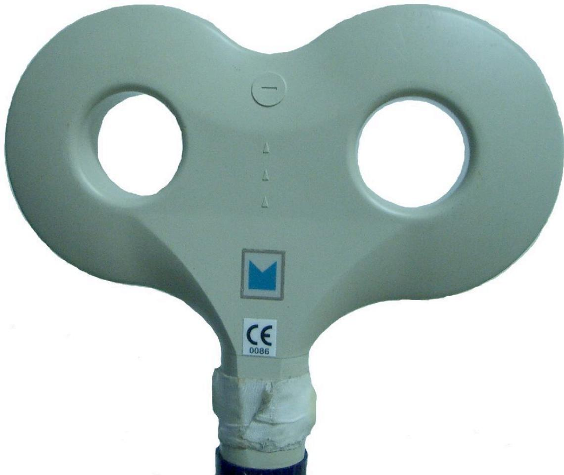
Abbildung 2.1: Die verwendete, achtförmige Spule (MagStim Typ P/N 9925).
