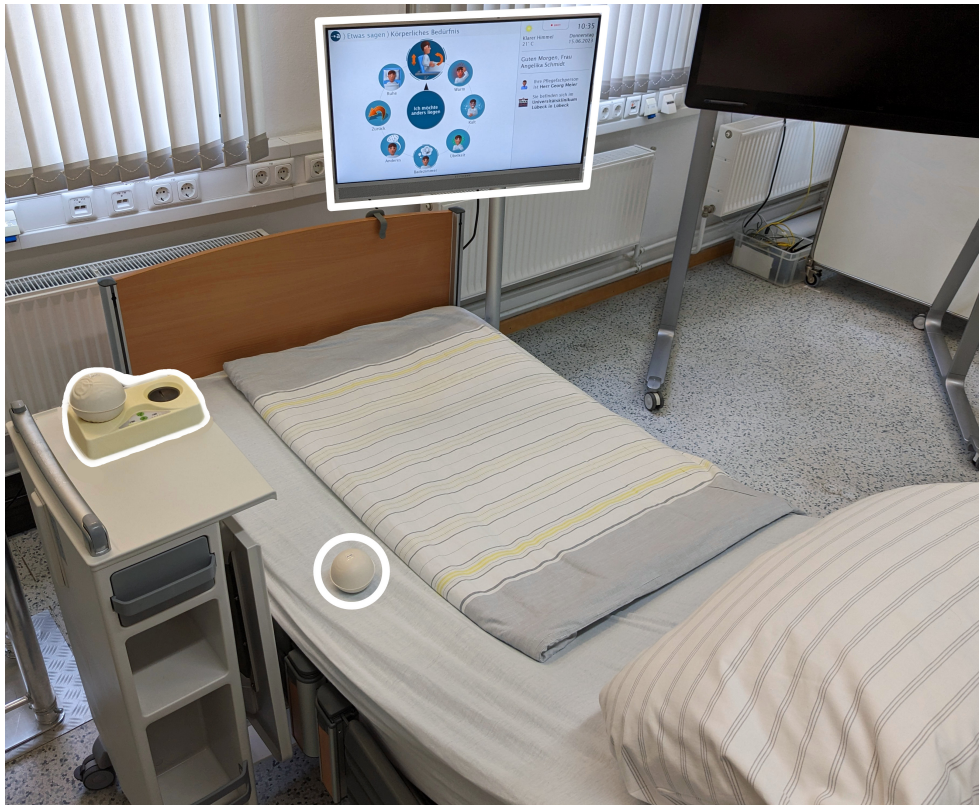
Abbildung 48: Laboraufbau der Nutzerstudie im COPICOH-Health-Lab der Universität zu Lübeck (nachgestellt). Die zentralen Komponenten wurden hervorgehoben: Auf dem Tisch steht die Ladestation, auf dem Bett liegt der aktive BIRBY und am Fußende des Bettes befindet sich der auf dem Rollständer montierte Bildschirm.
