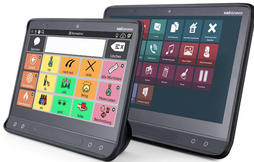
Abbildung 8: Tabletbasierte Kommunikationsgeräte der i-Serie von Tobii Dynavox mit gitterförmigem Menü-Design sowie Touch- und Augensteuerung als Eingabemodalitäten 3
