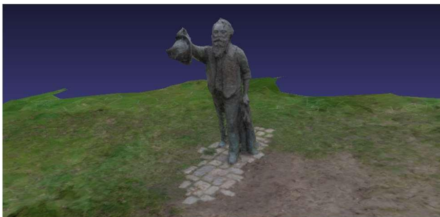
Abbildung 44: Bildschirmfoto eines 3D-Objektes, das mit NOC3D aus 225 Bildern, welche aus einer Videodatei extrahiert wurden, in einem automatisierten Prozess rekonstruiert wurde. Der blaue Hintergrund stammt von dem Programm zur Betrachtung von 3D-Objekten (Bouck-Standen et al., 2017).
