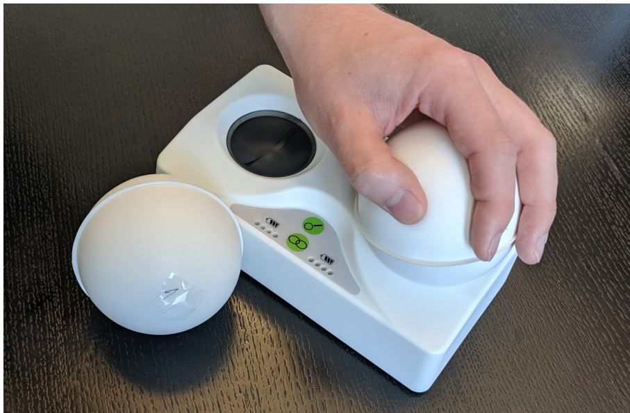
ABBILDUNG 8.6 – Zwei BIRDY-Demonstratoren in der zugehörigen Ladestation. Die Ladestation verfügt über eine Ladestandsanzeige der Handgeräte (gekennzeichnet durch die Batteriesymbole) und über zwei Taster zur Bluetooth-Kopplung (markiert durch die zwei sich überschneidenden Ringe) sowie zur Suche nach dem aktuell aktiven Gerät (versehen mit einem Lupen-Symbol).
