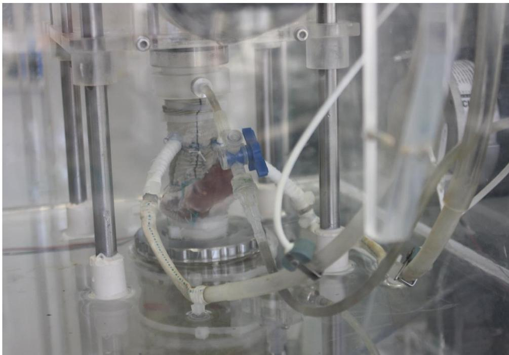
Abb. 28: Die Aortenwurzel ist in den Kreislaufsimulator eingespannt. Die Koronarien sind an die Messapparatur angeschlossen.
