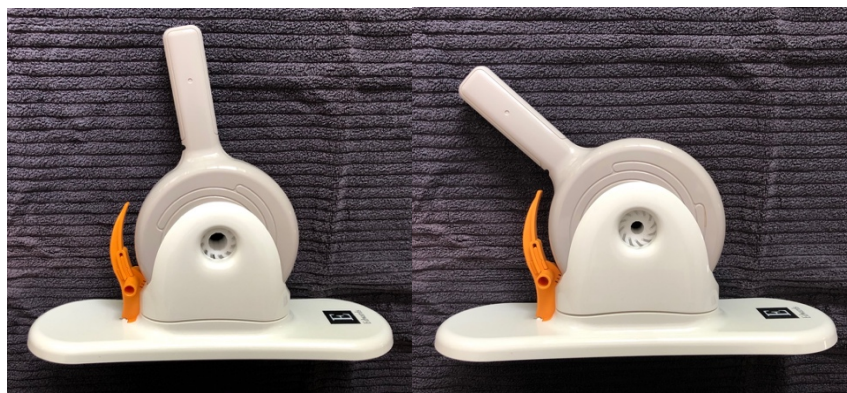
Abbildung 7: Valve Stent Crimper der Firma Edwards Lifesciences Corporation (Irvine, Kalifornien, USA) Links: geöffnet. Rechts: geschlossen. Foto: Arbeitsgruppe PD Dr. Richardt
