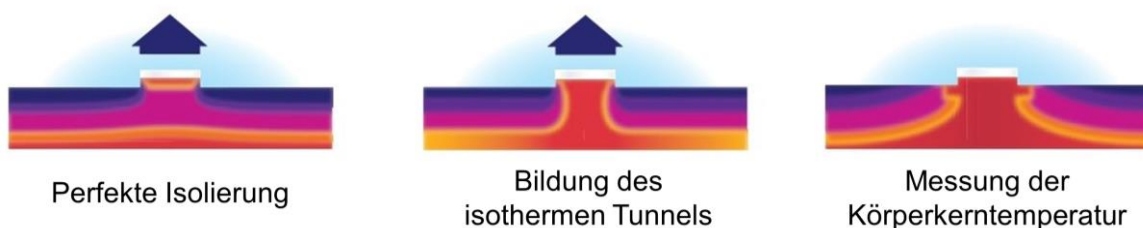
Abbildung 4: Etablierung des isothermen Tunnels, nach Bair Hugger™ Produktbroschüre [82] Mit freundlicher Genehmigung; Beschriftung gemäß Vorgabe Fa. 3M
