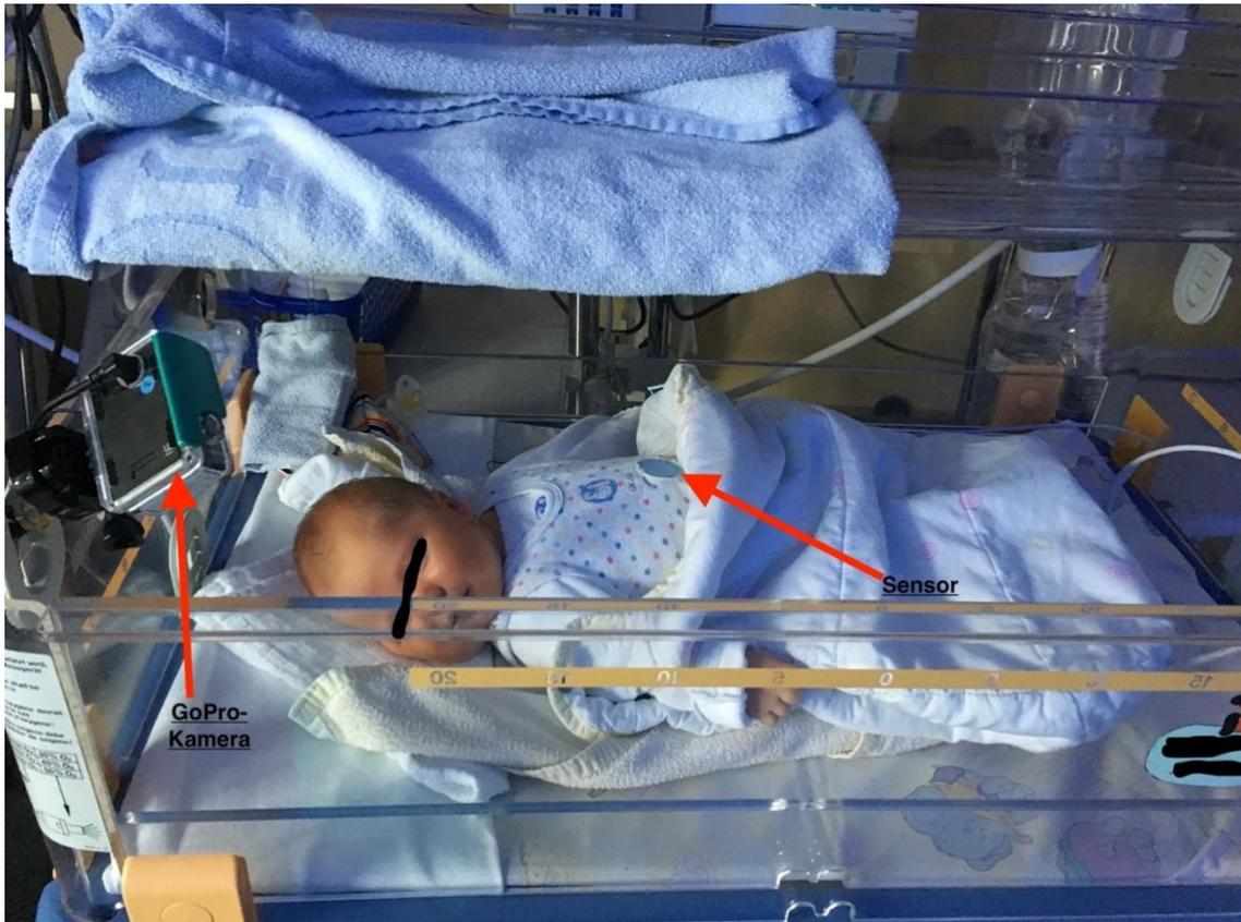
Abbildung 5: Versuchsaufbau mit einem schlafenden Probanden, bei dem zwischen Proc. Xiphoideus und Bauchnabel der Sensor befestigt wurde. Am linken Bildrand ist die Kamera sichtbar (siehe Pfeile)
