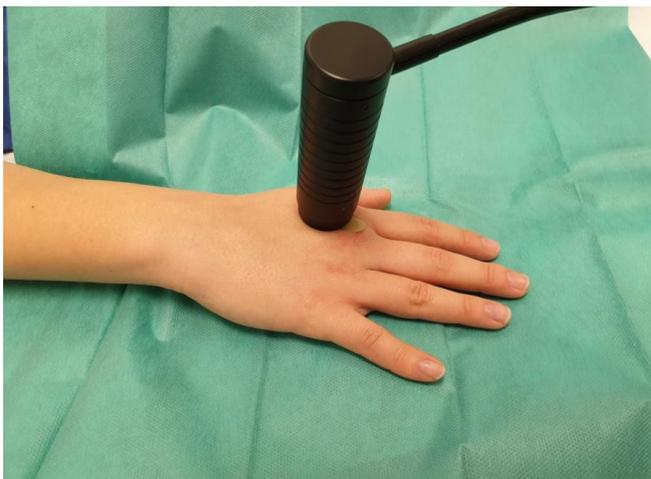
**Abb. 12. Messung mit dem Cutometer.**
