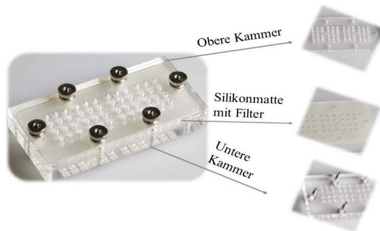
Abbildung 15 Aufbau einer 48-Well-Mikro-Chemotaxiskammer AP48 die im Boyden Chamber Versuch verwendet wird. Die Apparatur besteht aus einer unteren Kammer, einem Chemotaxisfilter, einer Silikonmatte und oberen Kammer. Die zwei Kammerteile werden mit Schrauben fixiert.
