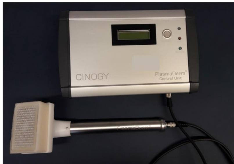
Abbildung 7 - PlasmaDerm®FLEX9060 - Gerät (CINOGY GmbH, Duderstadt) zur Applikation des kalten atmosphärischen Plasmas.
