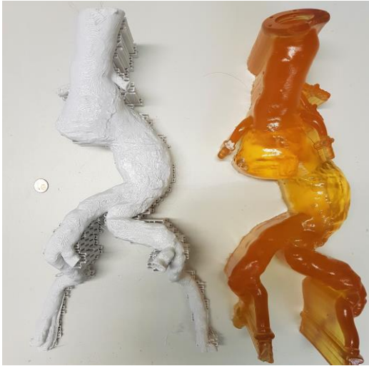
Abbildung 18: fertiger Druck des Modell 2; links FDM-Druck, rechts PolyJet-Druck
