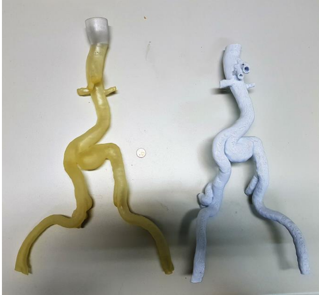
Abbildung 22: fertiger Druck des Modell 6; links PolyJet-Druck, rechts FDM-Druck
