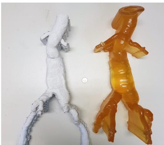
Abbildung 20: fertiger Druck des Modell 4; links FDM-Druck, rechts PolyJet-Druck
