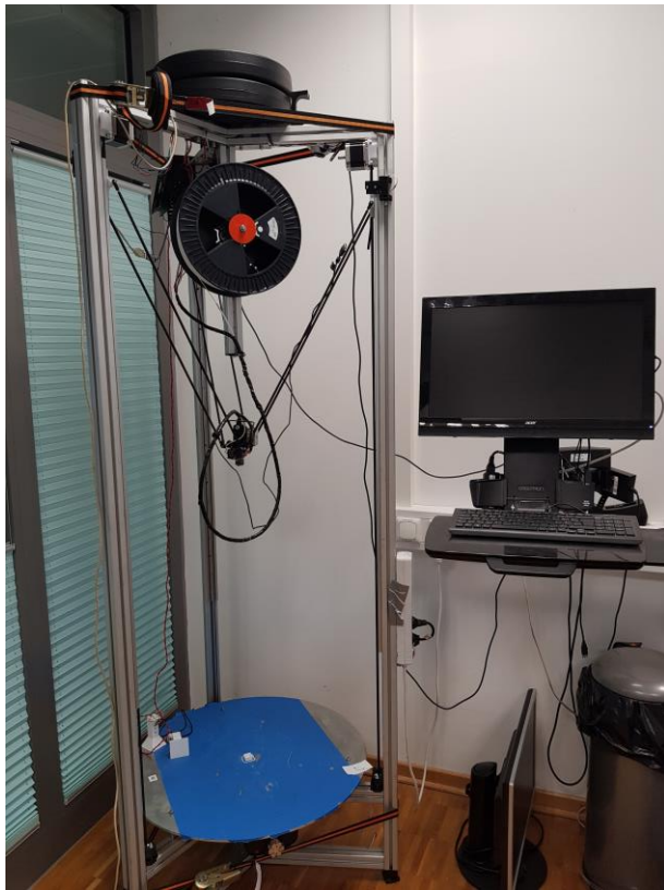
Abbildung 10: Delta-Kinematik des Instituts für Robotik und kognitive Systeme, Universität zu Lübeck
