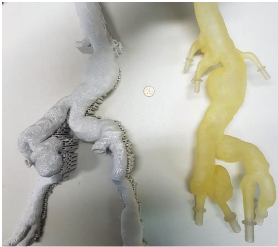
Abbildung 19: fertiger Druck des Modell 3; links FDM-Druck, rechts PolyJet-Druck
