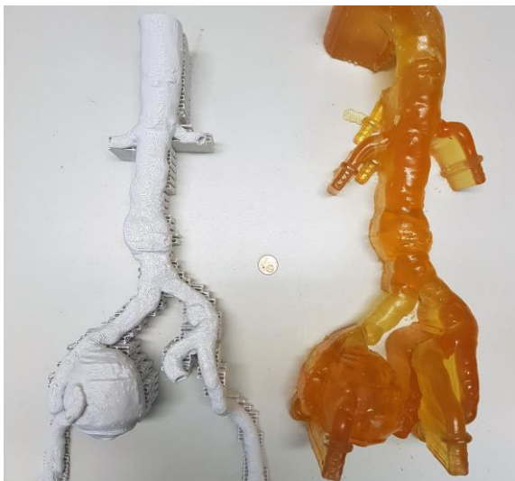
Abbildung 21: fertiger Druck des Modell 5; links FDM-Druck, rechts PolyJet-Druck
