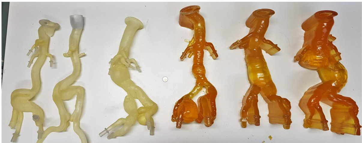
Abbildung 14: fertige PolyJet-Aortenmodelle; von links nach rechts: die ersten 3 Modelle (Modell 1, 6, 3 ) von ventral gesehen ohne Stützmaterial, die letzten drei Modelle (Modell 5, 4, 2 ) dorsale Ansicht noch von Stützmaterial umgeben; 1-Cent Stück zur Größenrelation beigelegt
