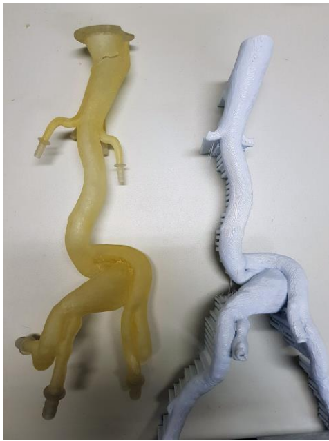
Abbildung 17: fertiger Druck des Modell 1; links PolyJet-Druck, rechts FDM-Druck
