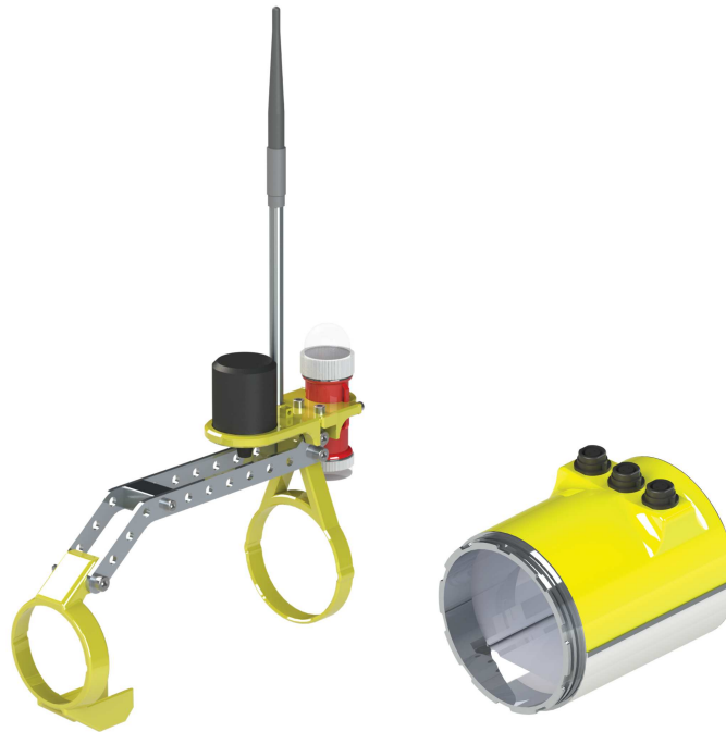
Abbildung 4.20.: Das Ozean-Kit des Unterwasserroboters Monsun bestehend aus einer externen Antennen- und Haltevorrichtung links und einem Interface-Modul rechts . Das mittig über die Bajonetttringe zu platzierende Modul stellt mehrere Schnittstellen für externe Geräte nach außen hin zu Verfügung, wodurch beispielsweise eine CTD-Sonde oder das Modem an den Roboter angeschlossen werden können. Die Antennen- und Haltevorrichtung wird direkt am Rumpf platziert und bietet neben einem Aluminiumbügel für erleichtertes Aussetzen und Bergen des Roboters auch einen Antennenturm, um die Erreichbarkeit von GPS und WiFi bei höherem Wellengang zu gewährleisten.
