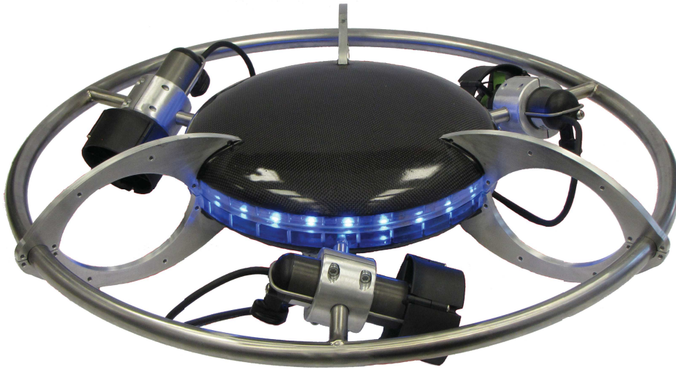
Abbildung 2.12.: Der Unterwasserroboter SMART-E kurz vor seinem ersten Einsatz 2013 beim SAUC-E Wettbewerb in La Spezia, Italien. Als druckfester Körper dient ein zweiteiliger Ellipsoid aus Glas- und Kohlefaser verstärktem Kunststoff, welches über einen großen Bajonetting aus Acrylglas geöffnet werden kann. Der Druckkörper beinhaltet die gesamte Elektronik und Steuerungskomponenten. Außerhalb des Ellipsoids befindet sich ein Ring aus Edelstahl, welcher von sechs Armen am Körper befestigt ist. In den Zwischenräumen befinden sich drei drehbar gelagerte Unterwassermotoren, welche zusammen den holonomen Antrieb erzeugen [MEOM13].
