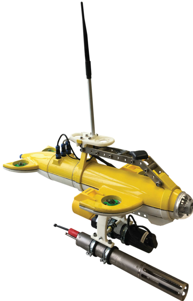
Abbildung 4.21.: Die Aktuelle Konfiguration des Monsun AUVs aus dem Sommer 2018. Der Roboter ist ausgestattet mit dem verstärkten Ozean-Kit, welches die verlängerten Antennen und das Interface-Modul beinhaltet. Der Geräteträger unter dem Rumpf des Roboters dient zur Aufnahme der CTD48 Sonde und des Akustikmodems. Zur Hindernisvermeidung ist in der Kuppel der optische Distanzsensor verbaut.
