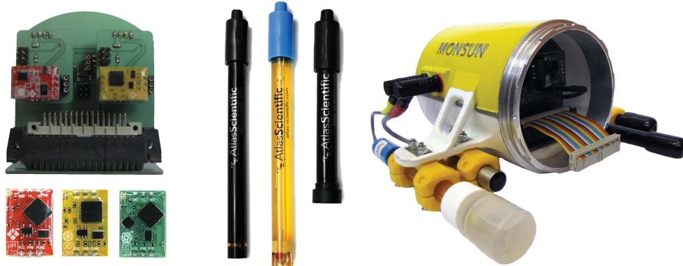
Abbildung 4.17.: Das Environmental Monitoring Modul des Monsun Unterwasserroboters. Als eigenständiges Zwischenmodul vereint es drei analoge Messsonden für Leitfähigkeit, pH-Wert und gelöstem Sauerstoff ( mitte ) in einem wasserdichten Gehäuse, welches über Bajonettringe im mittleren Teil des Roboters integriert wird ( rechts ). Mithilfe einer selbst entwickelten Elektronik ( links ) werden die Daten aller Messsonden zusammengeführt und aggregiert an den Roboter weitergegeben. Ein ebenfalls verbauter Temperatursensor wird für Temperaturkompensationen und einzelnen Sensoren verwendet, um die Genauigkeit der Messwerte weiter zu steigern. Hilfestellungen beim Entwurf wurden durch eine Bachelorarbeit von Frau Kim Scharringhausen gegeben [Sch15].
