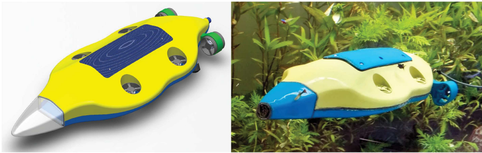
Abbildung 2.13.: Das Sembio AUV des Instituts für Technische Informatik der Universität zu Lübeck. Das Hauptaugenmerk bei der Entwicklung war ein energieeffizientes Design, welches auf der einen Seite durch eine strömungsgünstige Form und auf der anderen Seite durch ein Energiemanagementsystem realisiert wurde [28][BAMM18].
