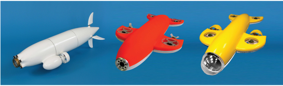
Abbildung 4.2.: Die drei Entwicklungsstufen des Monsun Unterwasserroboters in seiner Grundform. Die erste Generation (links) lieferte viele wichtige Erkenntnisse zur Weiterentwicklung und Konzeption der nachfolgenden Robotergenerationen. Das Antriebskonzept und Formgebung wurden bereits in der zweiten Generation (Mitte) komplett geändert, bevor die Finale Version unter Zuhilfenahme von modernen Fertigungstechniken entwickelt wurde [65, 66].
