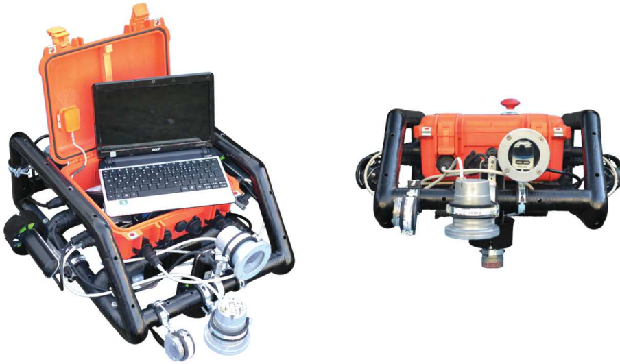
Abbildung 2.11.: Der Unterwasserroboter HANSE in seiner letzten Ausbaustufe im Jahr 2012. Die Hauptbestandteile sind ein wasserdichter Koffer, welcher von einem Rahmengestell aus Glasfaser verstärktem Kunststoffrohren umgeben ist. Zur Steuerung wird ein Laptop verwendet, welcher sich mit der restlichen Elektronik innerhalb des Koffers befindet. Außen am Rahmen sind vier Unterwassermotoren und Sensoren wie Kameras und Sonare installiert [FHK + 12].
