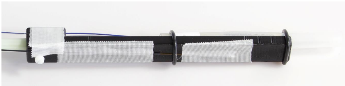
Abb. 6: Befestigung der Referenzsonde mittels Gewebeklebeband an der Unterseite der Halterung ohne Kontakt zur Gefäßprothese.
