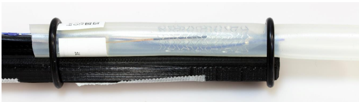
Abb. 5: Fixierung der Temperatursonde am „hotspot“ des Stents (Express Vascular LD 10 mm / 37 mm) mittels eines mit Luft expandierten Ballonkatheters.
