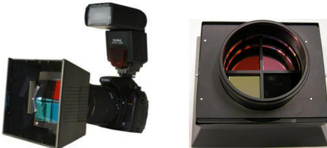
**Abb. 48.** Multispektralkamera *CS-CAM.burn* mit 4-Kanal-Filtervorsatz und Blitzlicht; Filtervorsatz von der Rückseite
