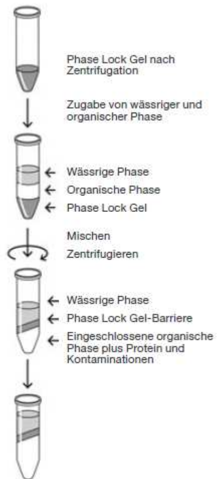
Abb. 3 zeigt die RNA-Isolierung nach dem Eppendorf Phase Lock Gel®-Verfahren [6].
