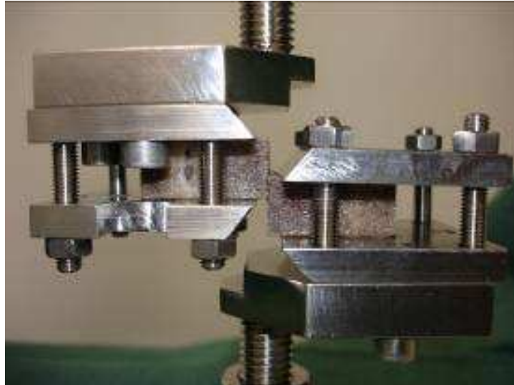
Abb. 24 Asnis-Schraube im Scherversuch
