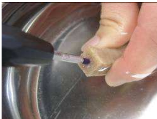
Abb. 8 Schweißen im Wasserbad
