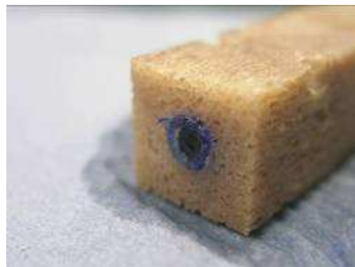
Abb. 9 Verschweißter Pin im Knochenblock
