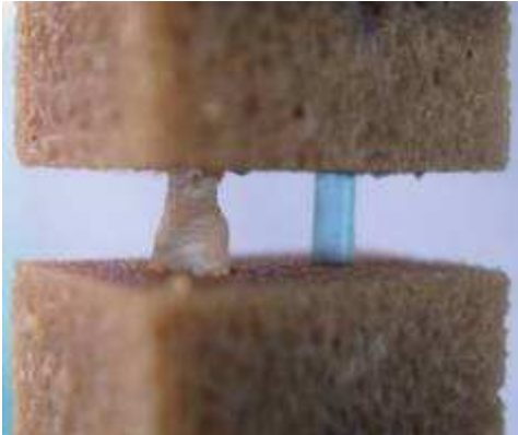
Abb. 21 Versagensmechanismus Inion OTPS System
