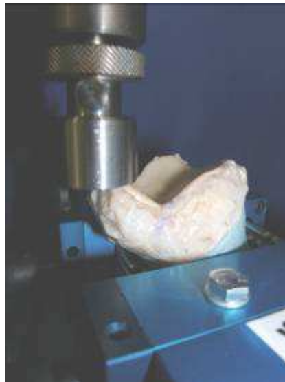
Abb. 18 Distale Tibia in der Prüfmaschine
