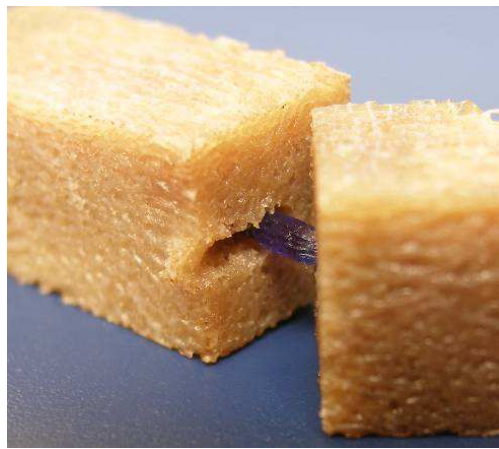
Abb. 26 SonicPin im Scherversuch
