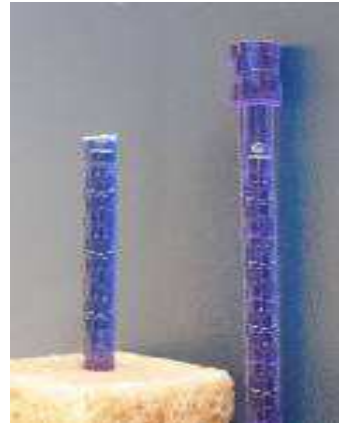
Abb. 22 Bruch des SonicPin unterhalb des Kopfes (im Ver- gleich mit einem intaktem Pin)
