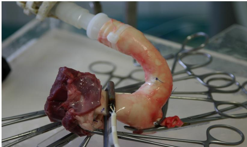
*Abbildung 4: Aorta eingebaut in das Wasser-Druck-System*
