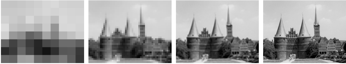
Abbildung 5.5: Diskrete Bilder mit unterschiedlich feinen Gittern. Die Auflösungen betragen v.l.n.r. : (8 \times 10) , (38 \times 50) , (76 \times 100) und (761 \times 1000) . Je feiner das Gitter ist, desto mehr Detailinformation ist in den Bildern enthalten.
