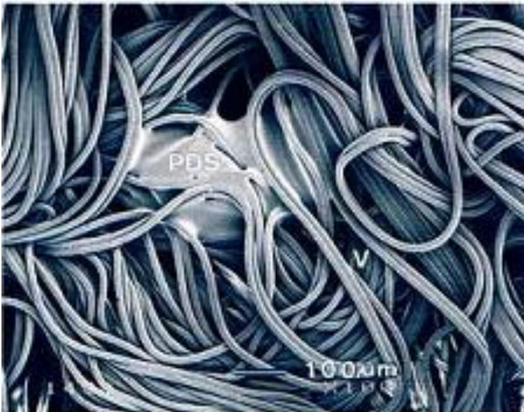
**Abb. 5** ETHISORB®-Vlies mit dreidimensionalem VICRYL®-Filamentgeflecht (V) und punktueller Verklebung durch eine PDS-Schmelze (PDS). Rasterelektronenmikroskopie, 70x.
